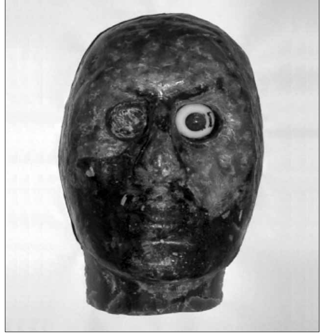
Şekil 1. Balmumu baş fantomu ve polystyrene göz fantomu.
