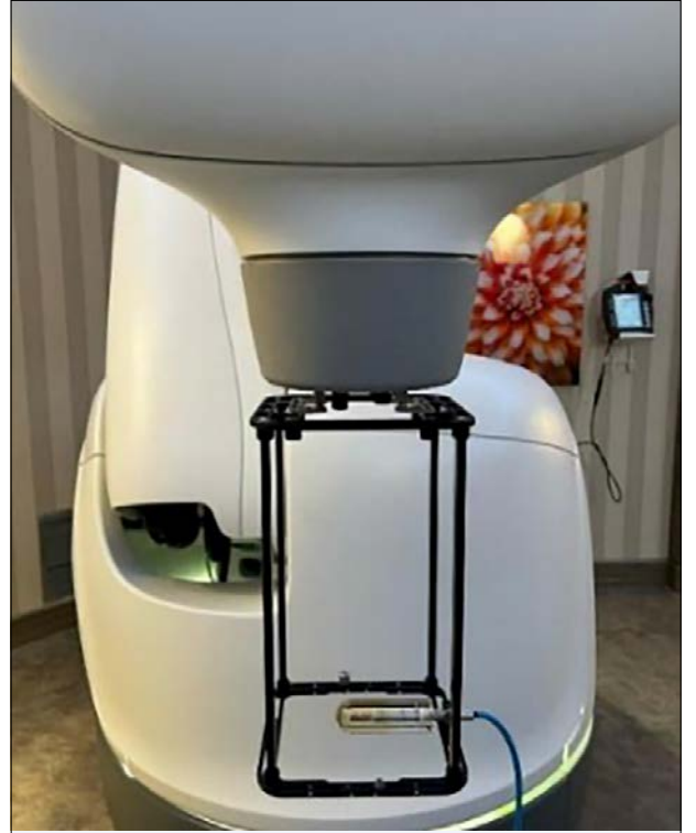
Şekil 1. Hızlandırıcı veriminin BirdCage ile ölçüm kurulumu.
