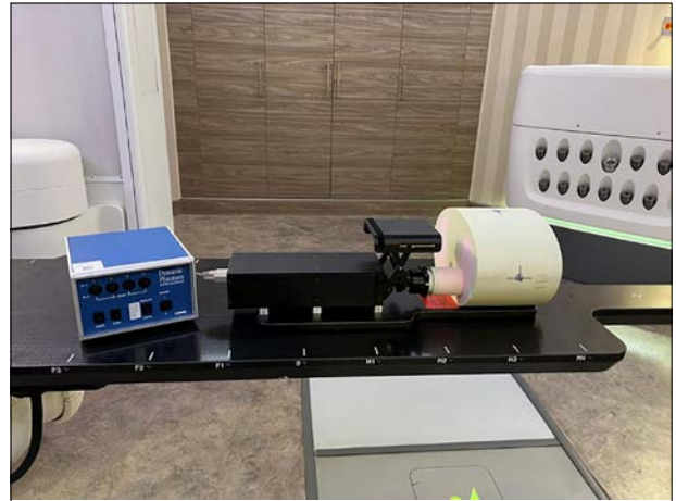
Şekil 7. X-Sight Lung E2E testi için kullanılan hareketli fantom. E2E: Uçtan uca.
